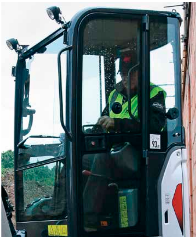
TOPS/ROPS-Kabine mit Heizung
