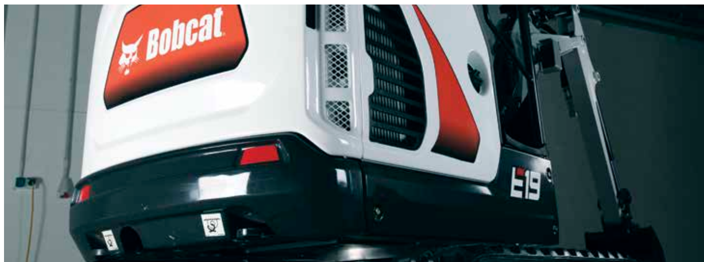
Gegossenes Gegengewicht schützt die Heckklappe
