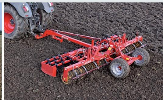
Avant SX 610-56 U mit Fahrwerk und Zugdeichsel mit 6 Steckern und 2 Hydraulikleitungen umgerüstet zur gezogenen Maschine
