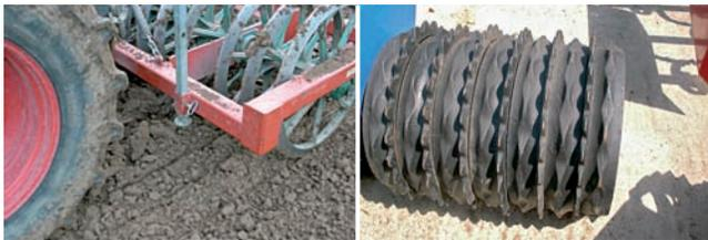
Packerringe mit schmalen Schneiden fahren wie Eisenbahnräder auf Schienen stur geradeaus. Lenkböcke sind deshalb unabdingbar.
