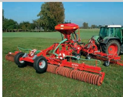
**GreenMaster**, das 5-in-1-System – für Grünland und Ackerbau: Das 1. effektive Gerät gegen Gemeine Rispel! Baukastensystem: Striegel und Walze getrennt oder kombiniert einsetzbar!
