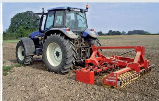
Die meisten Frontgeräte von Güttler lassen sich mittels eines Heck-Dreipunktturms umrüsten zum Kultivator am Schlepperheck
