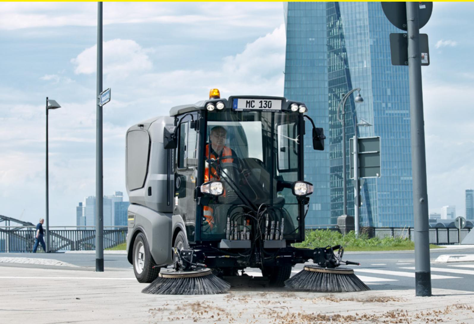
Entscheiden Sie sich für optimale Platzverhältnisse und wahlweise eine Ein- oder Zwei-Personen-Kabine mit ROPS. Setzen Sie auf Sicherheit durch die uneingeschränkte 360°-Rundumsicht, permanenten hydraulischen Allradantrieb und den abbremsbaren hydraulischen Geräteantrieb.
