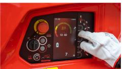
Das große Display an der unteren Station liefert zusätzliche Informationen zur oberen Station. Es ermöglicht den Technikern eine schnelle Diagnose oder die Abfrage des Speichers, dank einer intuitiven Navigation.
