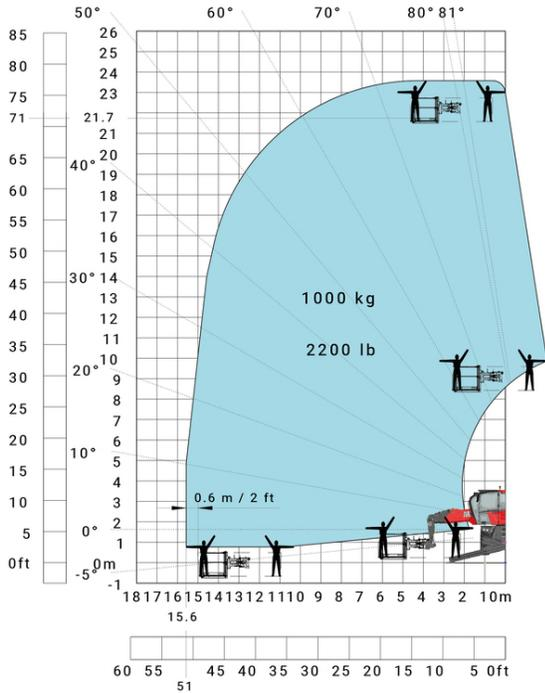
Drehung mit abgesenkten Stützen mit 3D positiv
