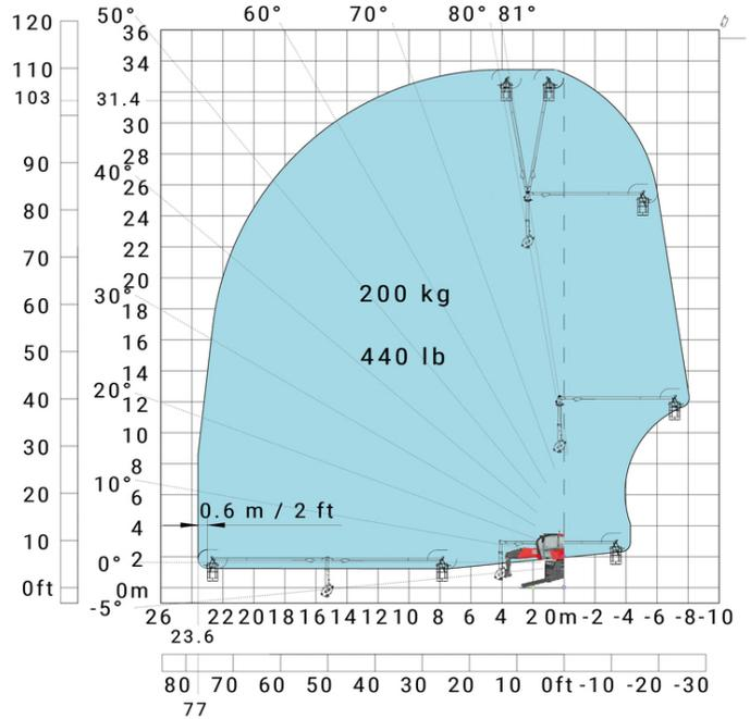
Drehung mit abgesenkten Stützen mit 3D negativ
