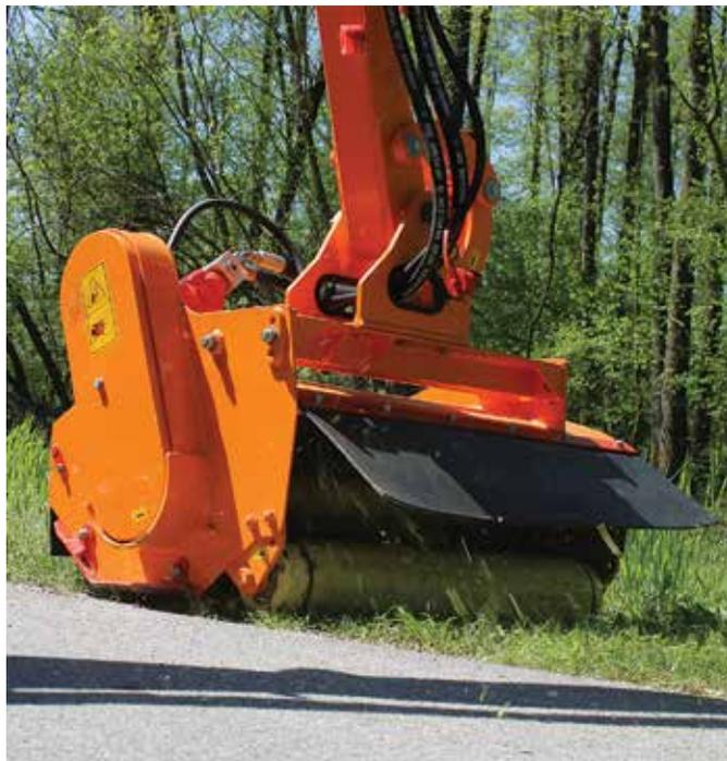
Minimierung der unkontrollierten Ablehnung des gemähten Materials. Die Vorderseite des Kopfes ist mit einem Schutzgummi und Ketten ausgestattet, während sich an der hinteren Seite ein Gummischutzvorhang befindet.
