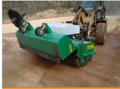
freikehrender Modus - Schmutzsammelbehälter hydraulisch arretiert
